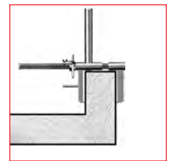
Instalación en peto
