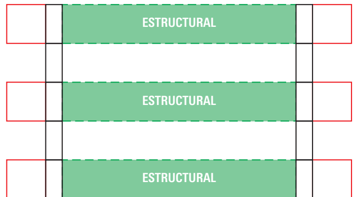
Posibles problemas en la alineación de los soportes que podrían provocar riesgos en la colocación de la cubierta
