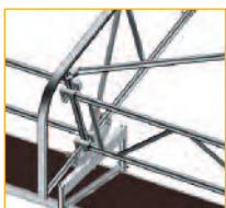
Conexión de diagonales en planta y de vigas transversales
