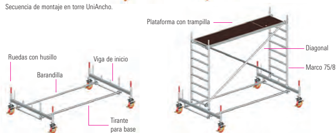
Secuencia de montaje en torre UniAncho.
